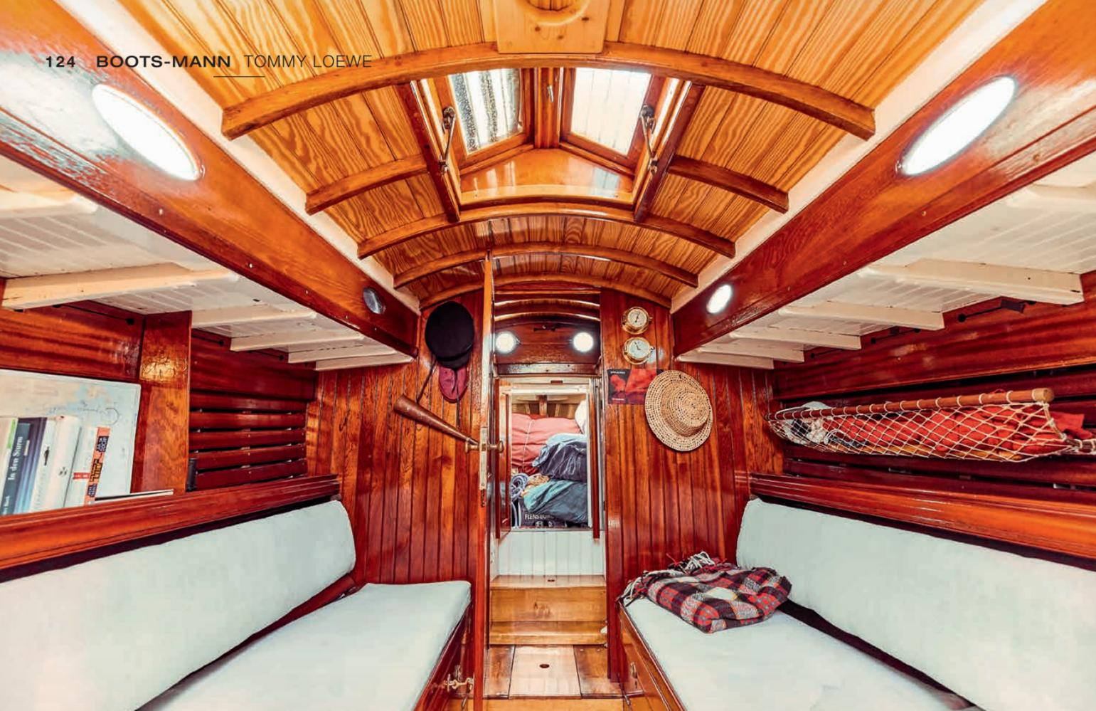
Der Salon konnte anhand des Vorbilds eines Schwesterschiffes am Bodensee und dank der Konstruktionszeichnungen aus dem Jahr 1918 wieder originalgetreu bis ins letzte Detail rekonstruiert werden
