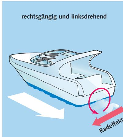
Eine **rechtsgängige Schraube** versetzt das Heck bei Vorwärtsfahrt etwas nach Steuerbord und bei Rückwärtsfahrt etwas nach Backbord. Eine linksgängige Schraube wirkt umgekehrt.
