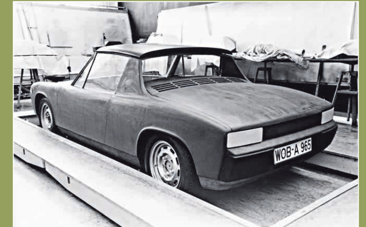
Typ 914, Modell 5, M. 1:1, August 67: Nur wenige Monate nach Klies wegweisendem Entwurf stand die Form des Porsche 914 fest. Ein funktionales, glattflächiges Automobil mit Platz für zwei und Gepäck – und mit Targa-Dach für den Spaß.
