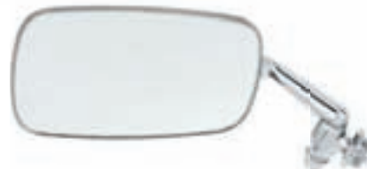
8/67: Cabrio-Version mit kurzem Gewinde
