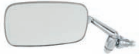
8/67: deutlich größer, Befestigung an der Tür
