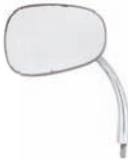
3/60: Änderung Befesti- gung, größer, Entfall Kunststoff-Umrandung
