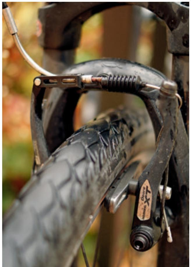
delle zeigen zudem nach einiger Zeit Schwächen, wenn die Bremsschenkel schwergängig werden und die Einstellbarkeit nachlässt. Für ein günstiges Pendlerrad mit nicht zu großem Anforderungsprofil sind V-Brakes aber allemal empfehlenswert. Insbesondere bei E-Bikes ist andererseits aufgrund von Gewicht und Geschwindigkeit von V-Brakes abzuraten.
