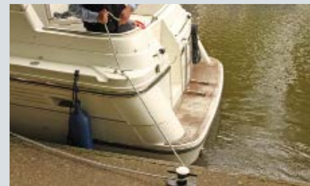
▲ Dichtholen der umgelenkten Leine.
