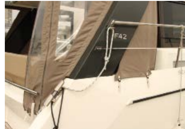
▲ Das Palstekauge, mit dem die Leine festgemacht werden soll, ist für die Crew auf dem Seitendeck griffbereit vorbereitet.
