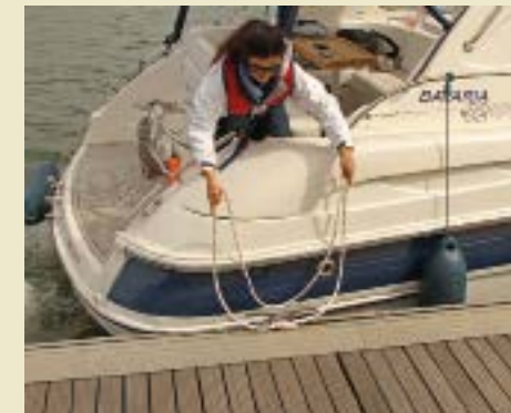
▲ Die Schlaufe wird um die Klampe gelegt.
